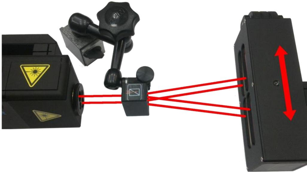
**FIG.7.16** CONFIGURACIÓN DE LA RUTA ÓPTICA PARA MEDICIONES DE RECTITUD DE WOLLASTON EN EL EJE Z.
