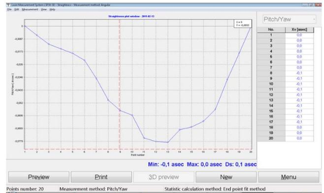
**FIG.16.8.** VENTANA DE ANÁLISIS DE DATOS MEDIDOS DE PITCH/YAW
