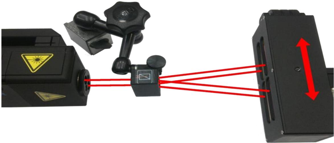
FIG.13.11. CONFIGURACIÓN DE RUTA ÓPTICA PARA MEDIDAS DINÁMICAS DE RECTURA EN EL EJE Z
