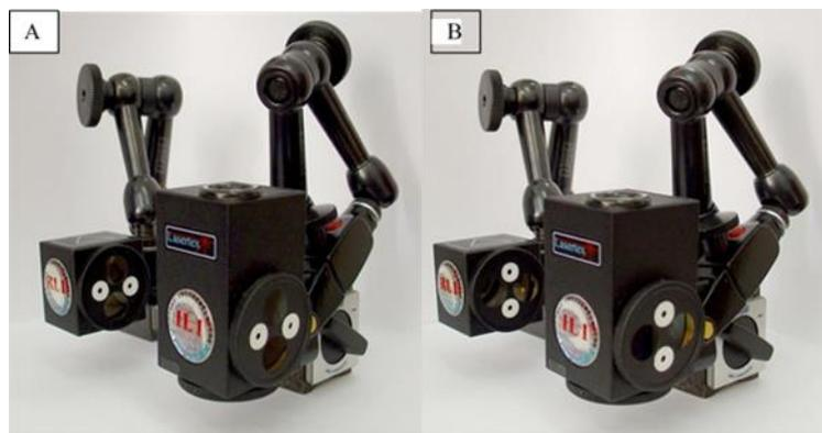
FIG.4.5. DIAFRAGMAS: POSICIÓN DE ALINEACIÓN (A) Y POSICIÓN DE TRABAJO (B)
