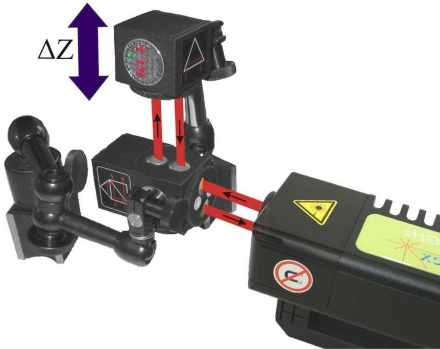
FIG.15.3. CONFIGURACIÓN DE RUTA ÓPTICA PARA MEDIDAS DE VELOCIDAD EN EL EJE Z
