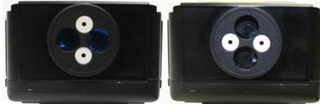
FIG.4.4. POSICIONES DEL DIAFRAGMA. A) MEDICIÓN, B) ALINEACIÓN
