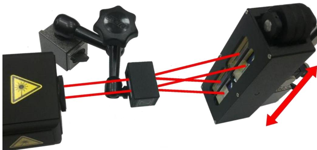
**FIG.7.15** CONFIGURACIÓN DE LA RUTA ÓPTICA PARA MEDICIONES DE RECTITUD DE WOLLASTON EN EJE X.
