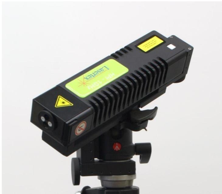
**FIG.4.5.** ELEMENTOS DE ALINEACIÓN DEL CABEZAL LÁSER
