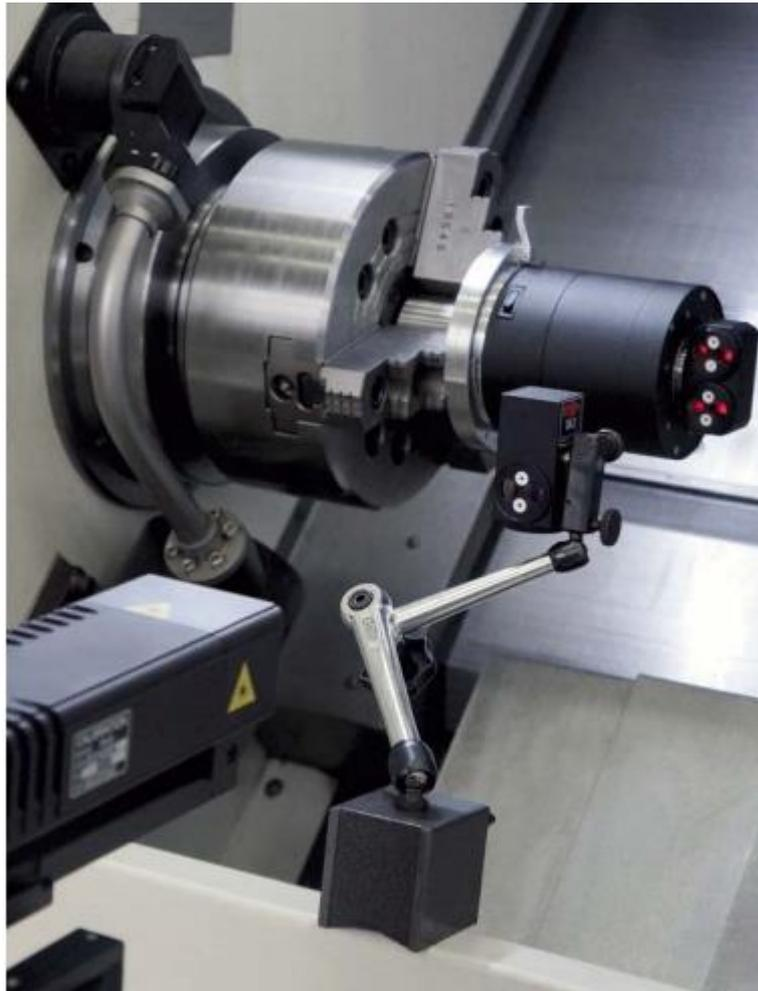
**FIG.14.2.** CONFIGURACIÓN DE RUTA ÓPTICA PARA MEDICIONES DE POSICIONAMIENTO ANGULAR
