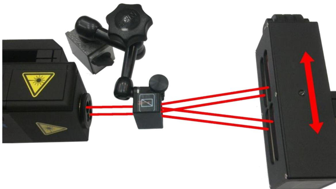
**FIG.7.16** CONFIGURACIÓN DE LA RUTA ÓPTICA PARA MEDICIONES DE RECTITUD DINÁMICA WOLLASTON EN EJE Z.
