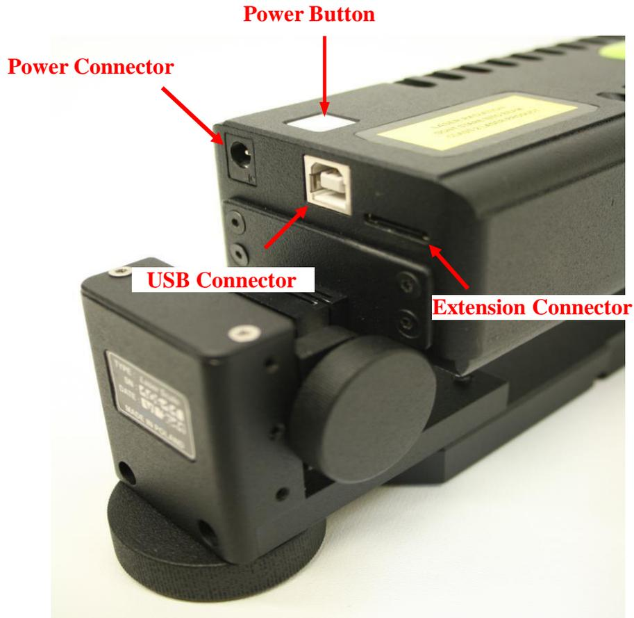
**FIG.3.20.** CONEXIONES DEL HPI-3D.
