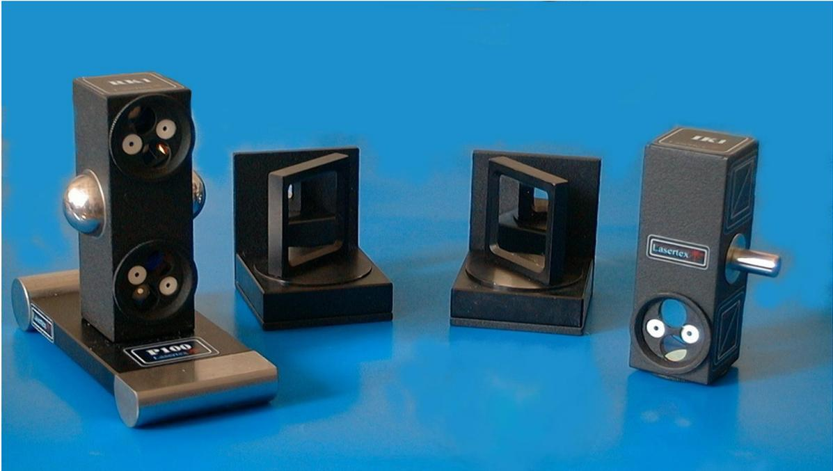
**FIG.8.2.** CONJUNTO DE ELEMENTOS PARA LAS MEDIDAS DE PLANITUD (IK1, RK1 Y ZK1).
