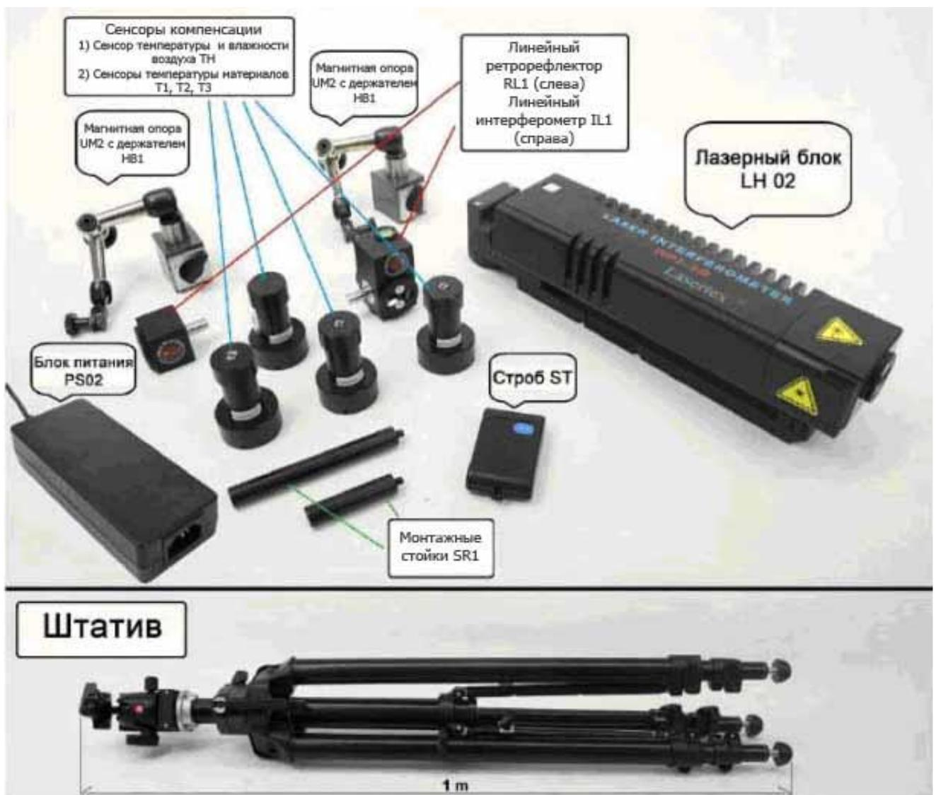
Рисунок 2 - Комплектность Интерферометров
